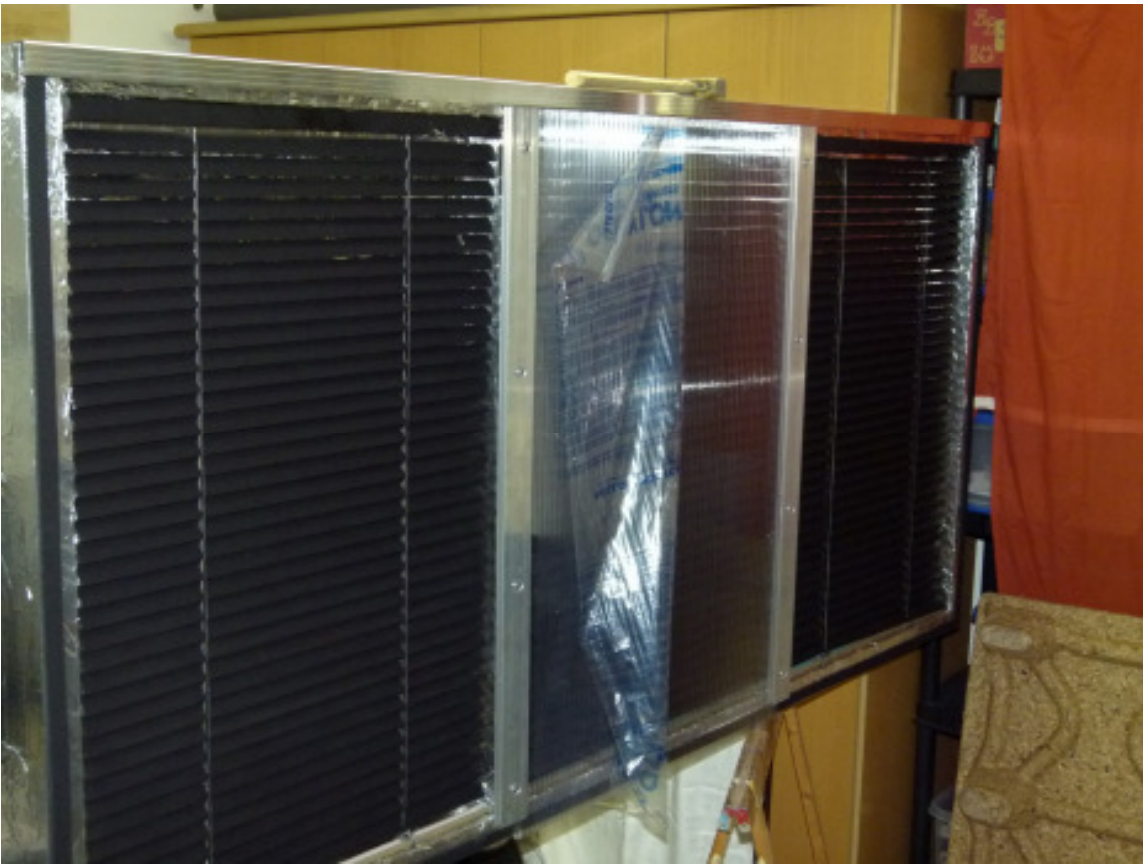
Kollektor im Mittelteil bereits mit 10mm Polycarbonat Doppelstegplatte bestückt.
