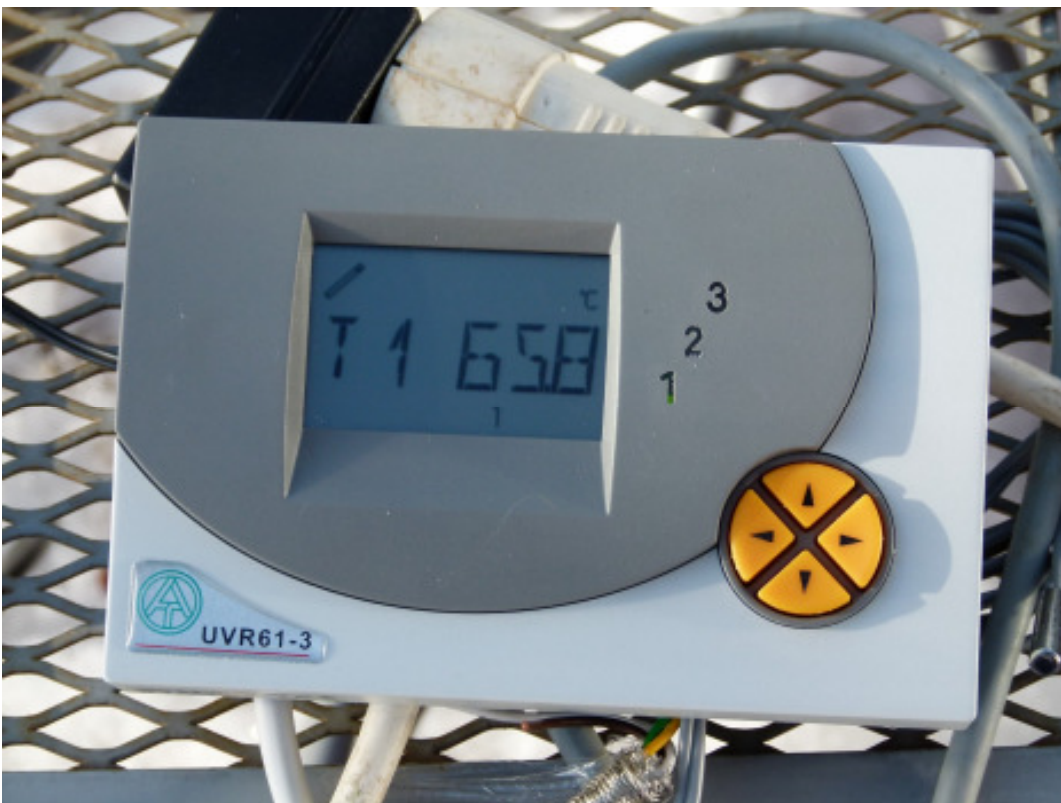
Die Kollektorausgangstemperatur erreichte einen Spitzenwert von 65,8°C.
